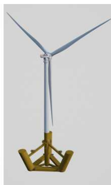
Figure 86 : Type et caractéristique d'éolienne flottante du projet DCNS - GE
